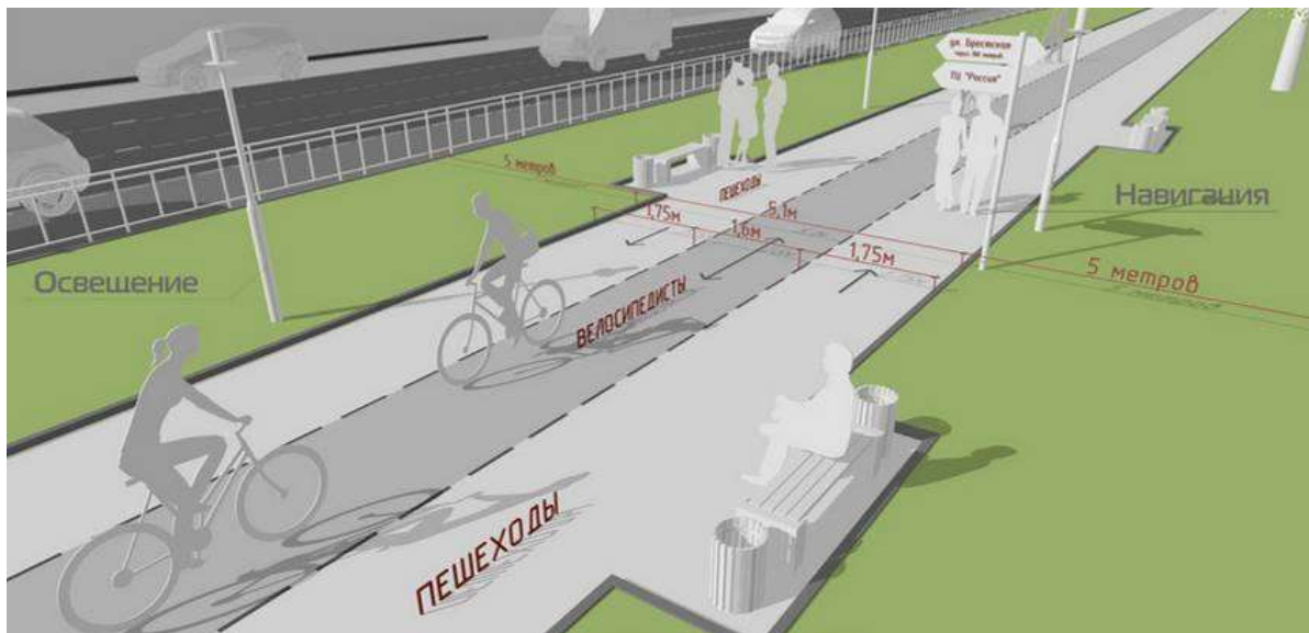
Рисунок 8 – Схема по устройству тротуаров с твердым типом покрытия
