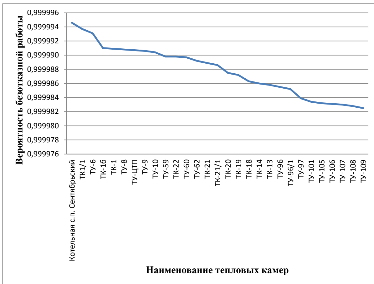
Рисунок 9.5 - ВБР относительно тепловых камер участка «Котельная – ТУ – 109/1»
